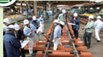
本邦分岐器工場での出荷前検査
